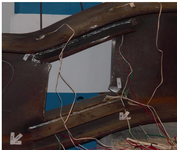
Figura 5.36 Deformações na abertura na rotura
