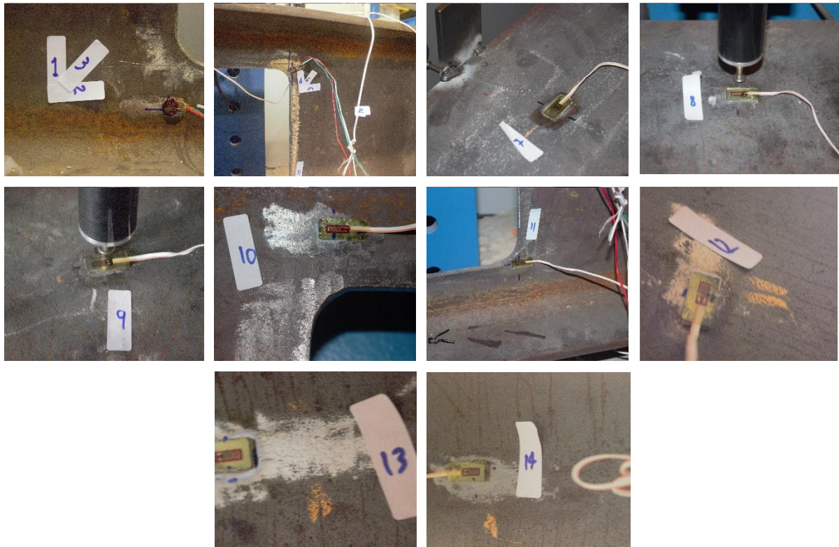
Figura 5.9 Extensómetros na viga V1 com pormenor dos extensómetros na abertura
