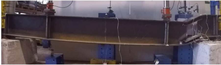
Figura 5.35 Deformada final da viga V2
