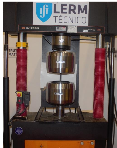
Figura 5.2 Instron, modelo 1343 utilizada nos ensaios de caracterização dos materiais.
