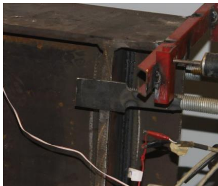
Figura 5.7 Chapas metálicas colocadas na extremidade para evitar deslocamentos laterais
