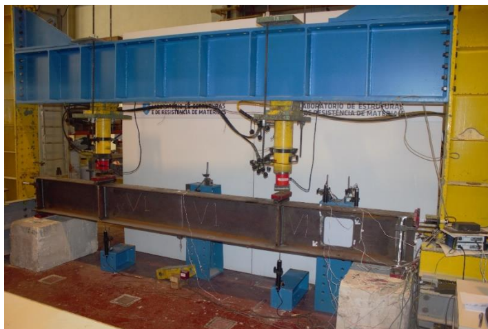
Figura 5.6 Pórtico no qual foi realizado o ensaio da viga V1
