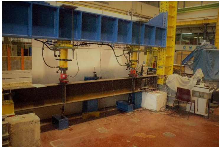
Figura 5.30 Pórtico instrumentado para o ensaio da viga V2
