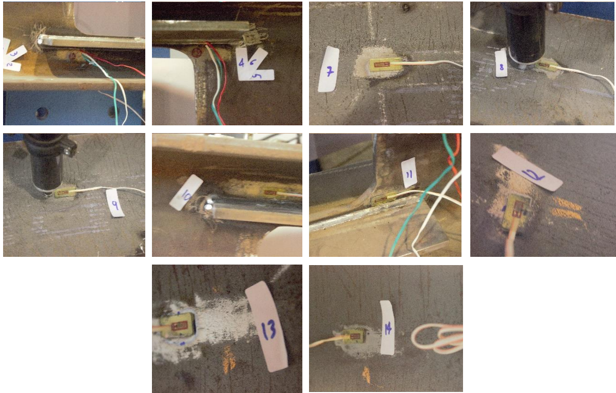
Figura 5.33 Documentação fotográfica da posição dos extensómetros em V2
